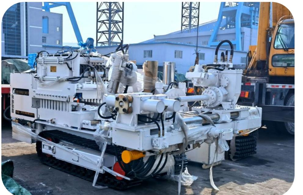
近日，孟村矿引进了一台CMSI-4500/55Y型智能卸压钻机，该设备投入使用后将实现防冲卸压自动化、智能化，全面提升矿井灾害治理水平和安全保障能力。
